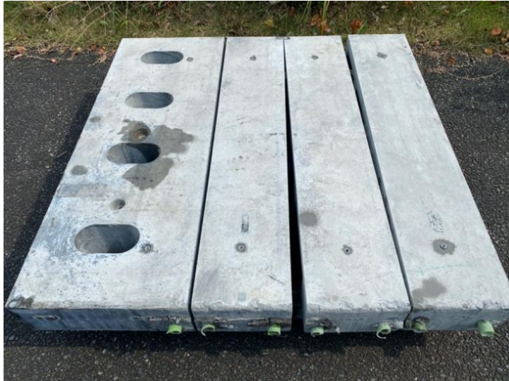
写真 輪荷重試験後、梁に切り出し
