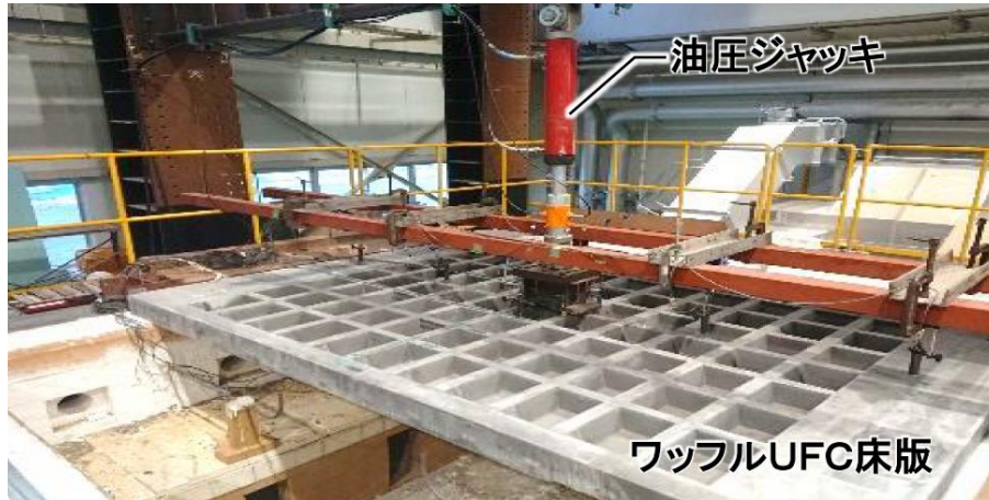
写真 床版上面の加熱試験状況
